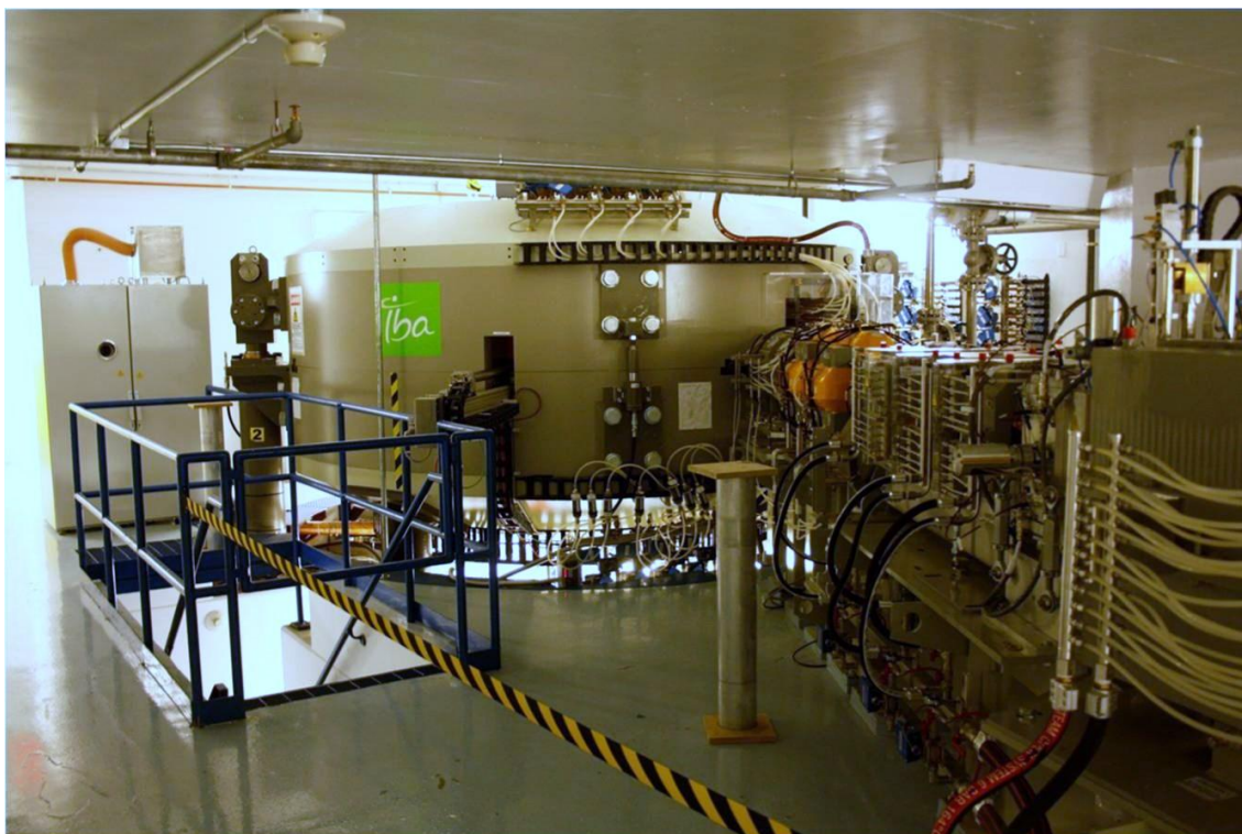
Figur 1: Protonacceleratorn. Bilden visar protonacceleratorn i Skandionkliniken. Protonstrålen går ut från acceleratorn och kommer mot betraktaren till höger i bilden och leds med magnetfält. Bildkälla: Akademiska Hus.
